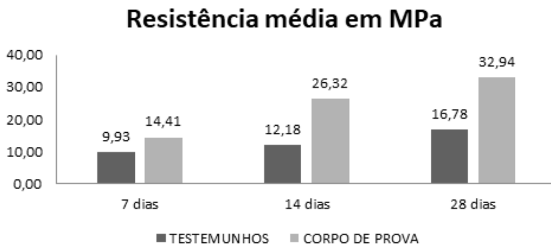
Gráfico 2: Resistência Média dos corpos de prova e dos testemunhos com concreto de 20 MPa
