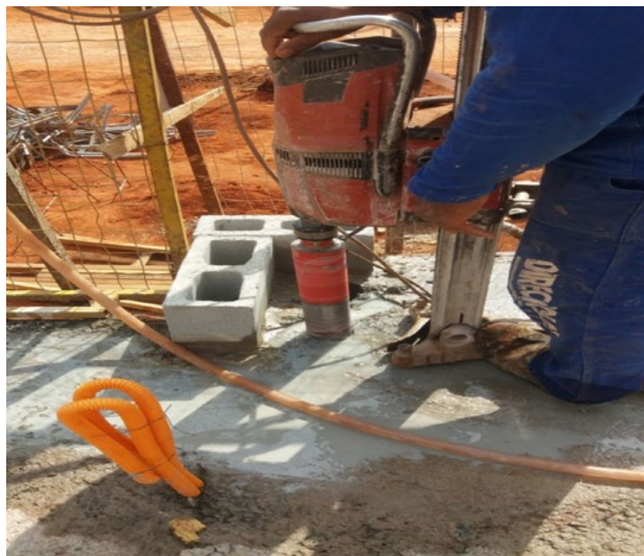
Figura 4: Extração dos testemunhos
