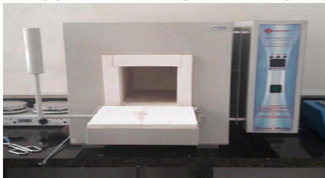
Figura 2: Equipamento utilizado no aquecimento dos corpos de prova.
