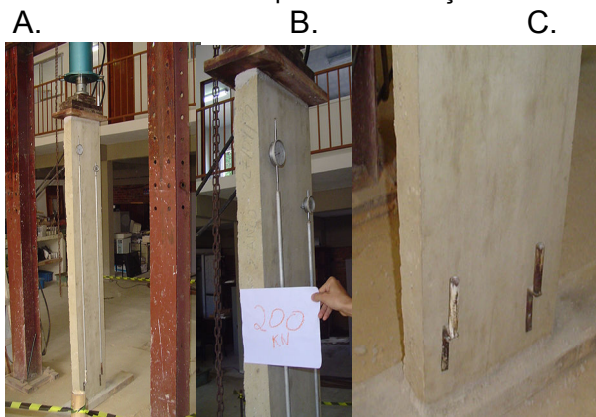
Figura 11 - A. Parede antes do ensaio; Figura 11B. Parede em bom estado com 200 kN; Figura 11C. Parte inferior em perfeitas condições.
